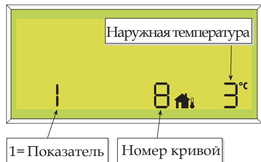
Пример параллельного изменения конфигурации кривых
